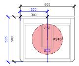
\*CORIAN TOP EXTENDS 5MM ON LEFT, RIGHT AND FRONT FOR BULLNOSE EDGE DETAIL
