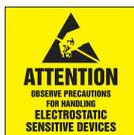
**ATTENZIONE:** Questo prodotto utilizza semiconduttori che possono essere danneggiati da scariche elettrostatiche (ESD). Quando si maneggia la scheda a circuiti stampati, bisogna fare attenzione a non danneggiare l'elettronica.
